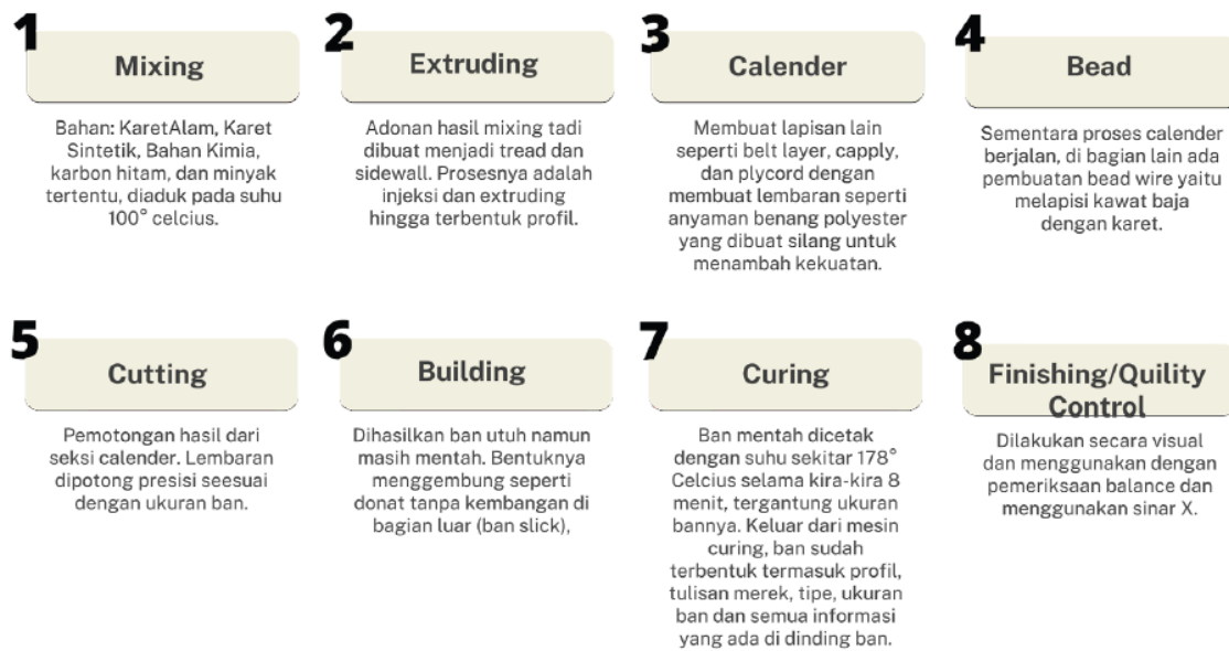
Gambar 2-4 Tahapan Pengolahan Karet Alam untuk Pembuatan Ban
