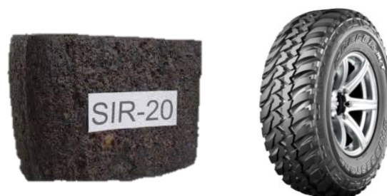
Gambar 2-3 Karet Padat SIR 20 sebagai Bahan Baku (kiri) dan Produk Ban OTR dari Bridgestone Tire (kanan)
